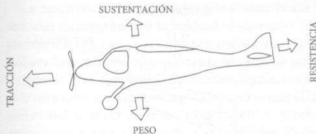
**Figura 13a.** En un avión con motor, la resistencia al avance se iguala con la tracción que proporciona el motor. Por otro lado, el peso del avión se iguala con la fuerza de sustentación creada en las alas, ya que si la sustentación fuese mayor, el avión sube, mientras que si la sustentación es menor que el peso, el avión entra en picado.
